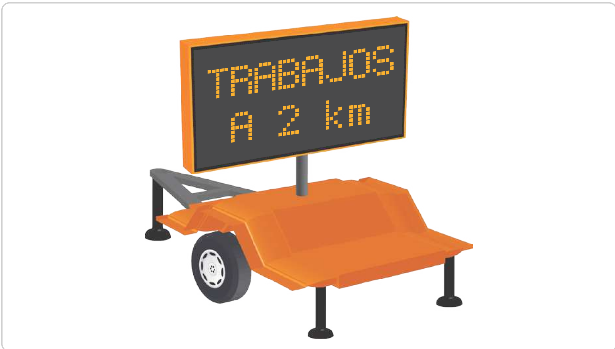
Figura 7-20. Señal de mensaje variable
