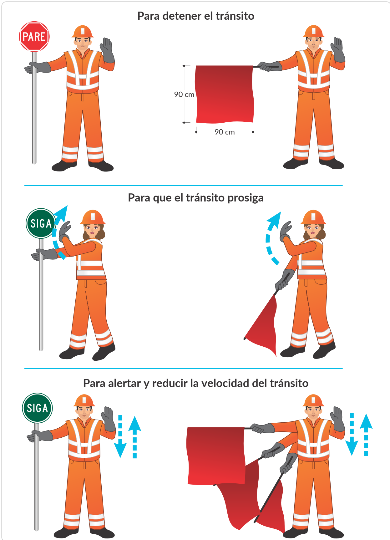
Figura 7-24. Operaciones con indicaciones PARE y SIGA
