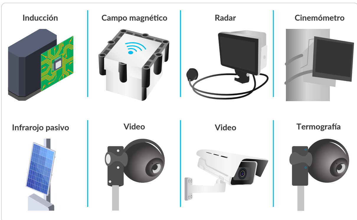
Figura 9-30. Elementos de detección típicos en SAT
