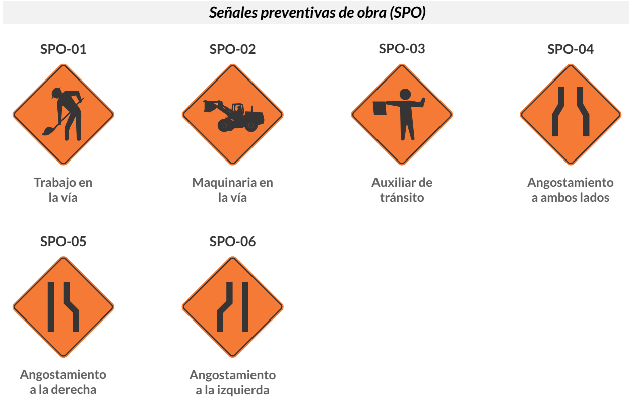
Figura 7-5. Señales preventivas propias de obra y señales de obra (continuación)
